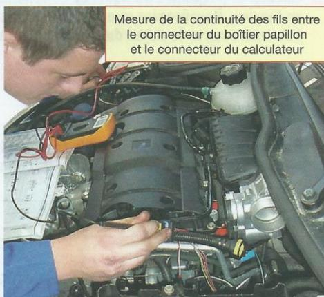
Mesure de la continuité des fils entre le connecteur du boîtier papillon et le connecteur du calculateur
