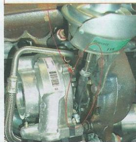
**6 Expliquer pourquoi les valeurs mesurées de la pression de régulation de suralimentation ne sont pas valides. Citer les conditions de mesure pour obtenir les résultats réels.**
