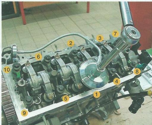
**8 Tracer l'évolution du rapport volumétrique si par rectification on enlève 0,4 mm, 1 mm, 1,5 mm et 2,2 mm sur le plan de joint de la culasse (même joint). On prendra comme hypothèse que le diamètre à la base de la chambre de combustion, de forme cylindrique, est équivalent à celui du cylindre.**
