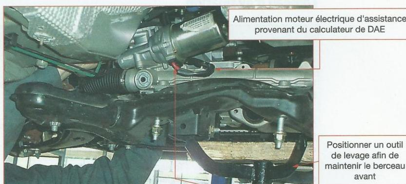
Déposer la vis du cardan de direction puis dégager celui-ci en tirant sur la partie de la colonne de direction
