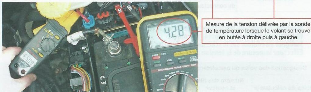
**10 Refaire le contrôle de la tension aux bornes de la sonde de température lorsque le volant est en position de butée à droite, puis à gauche.**
