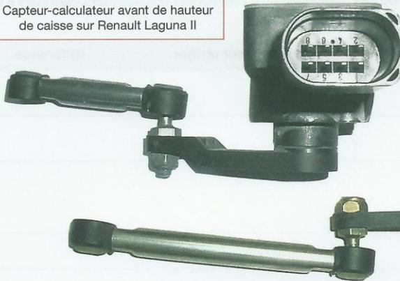
Capteur arrière de hauteur de caisse sur Renault Laguna II
