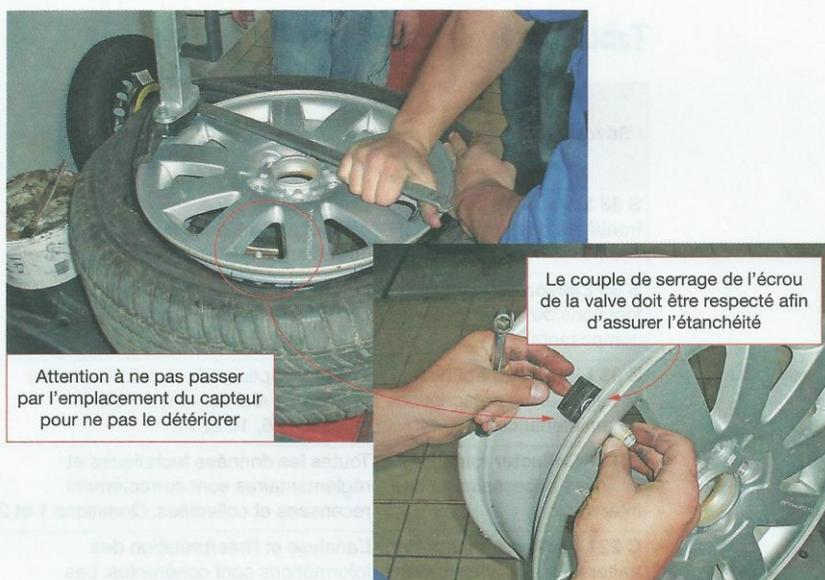
Attention à ne pas passer par l'emplacement du capteur pour ne pas le détériorer
