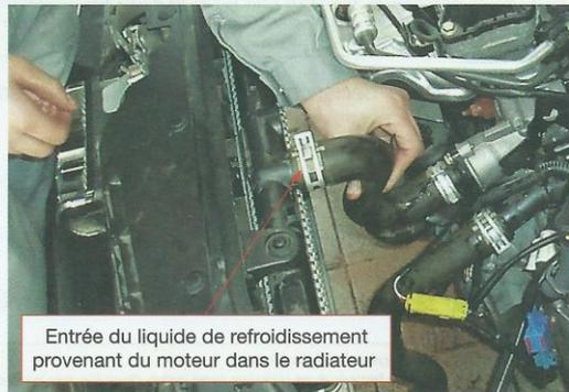
Entrée du liquide de refroidissement provenant du moteur dans le radiateur
