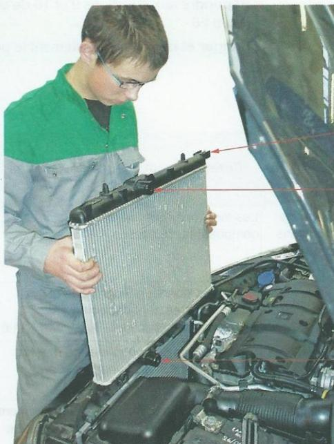
Exemple du remplacement du radiateur de refroidissement d'un moteur TU5JP4 code NFU (Peugeot 206 1.6i)
